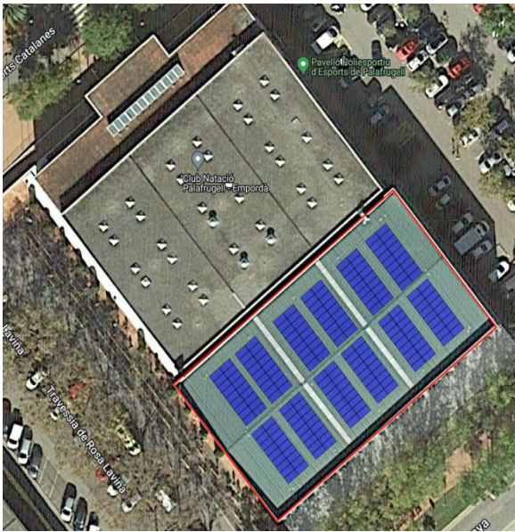
Imatge 2 .- Distribució panells solars coplanars sobre la coberta (Font: K2 Base)
