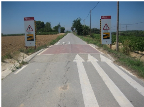
Plataforma reductora de velocitat en secció
