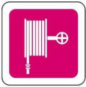
SI-170 BOCA DE INCENDIO
