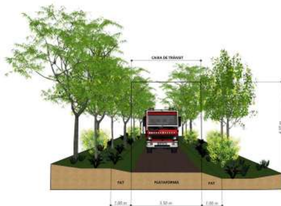
Figura 2. Parts d'un vial de la XVB; plataforma de rodament i FAT (amplades mínimes)
