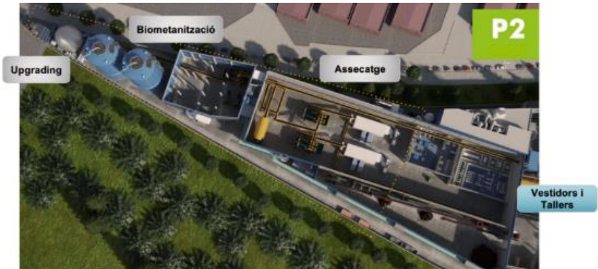
Figura 19. Detall de distribució d'espais del procés d'assecatge i de les noves instal·lacions de vestuari i tallers a l'espai del procés actual de bioestabilització de MOR.
