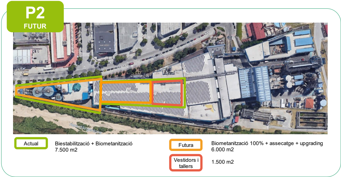
Figura 18. Visualització de la ocupació de les instal·lacions de tractament biològic i assecatge del bioestabilitzat, així com la implantació des vestidors i tallers del CIVRM.
