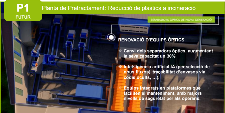
Figura 14. Integració dels nous equips de separació òptica dins l'àrea de pretractament.
