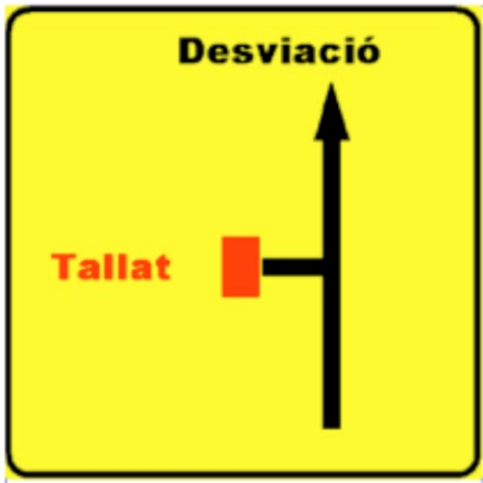
Pancartes i pals tubulars metàl·lics Fons groc, lletres negres Alçària: 150 mm mínim. Lletra Helvetica Medium Condensed. Tall vermell.
