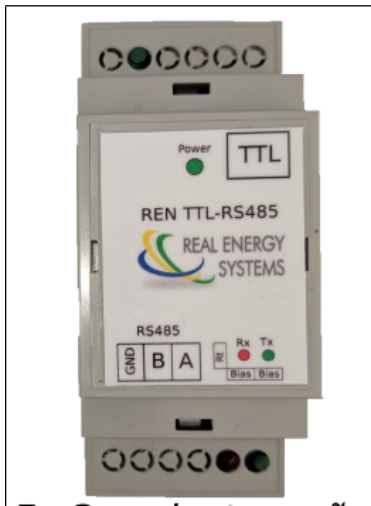
Figura 5: REN-TTL-485: Convierte señal TTL en bus RS485 (incl. aislamiento galvánico)
