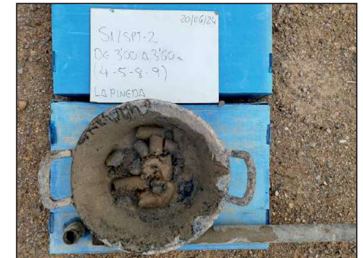
Assaig SPT realitzat entre 3,0 i 3,6 m.
