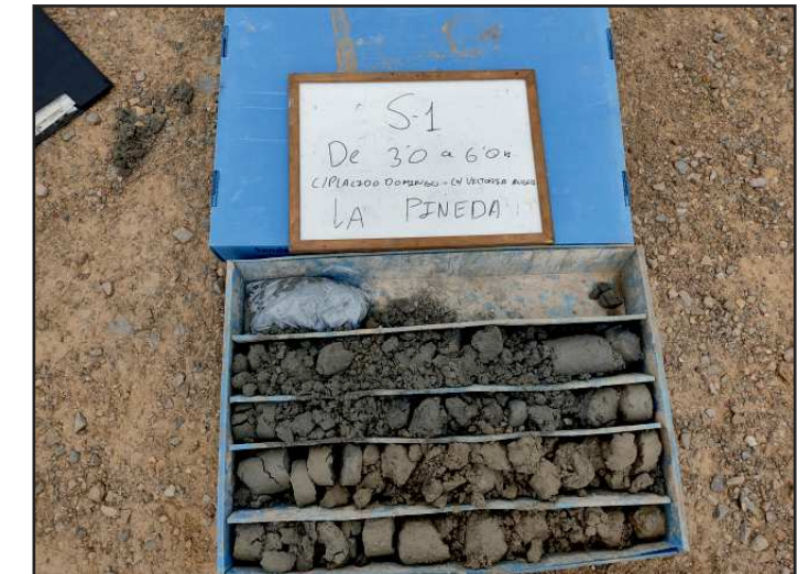
Caixa de testimonis del sondeig S-1 entre 3,0 i 6,0 m.
