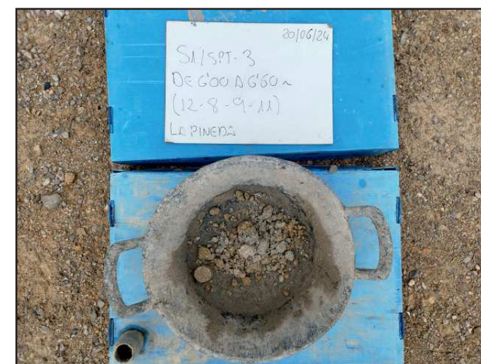
Assaig SPT realitzat entre 6,0 i 6,6 m.
