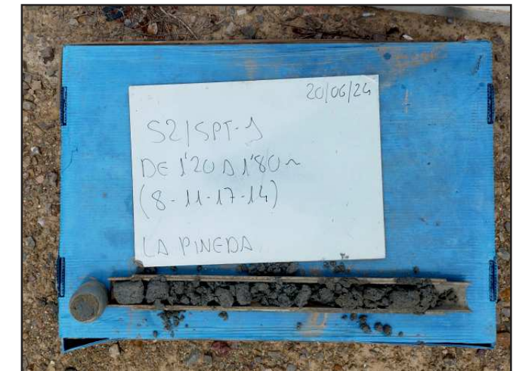
Assaig SPT realitzat entre 1,20 i 1,80 m.
