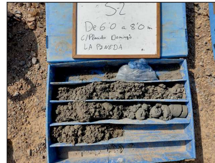
Caixa de testimonis del sondeig S-2 entre 6,0 i 8,0 m.
