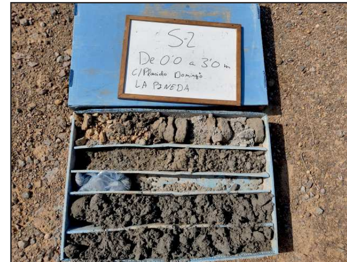
Caixa de testimonis del sondeig S-2 entre 0,0 i 3,0 m.
