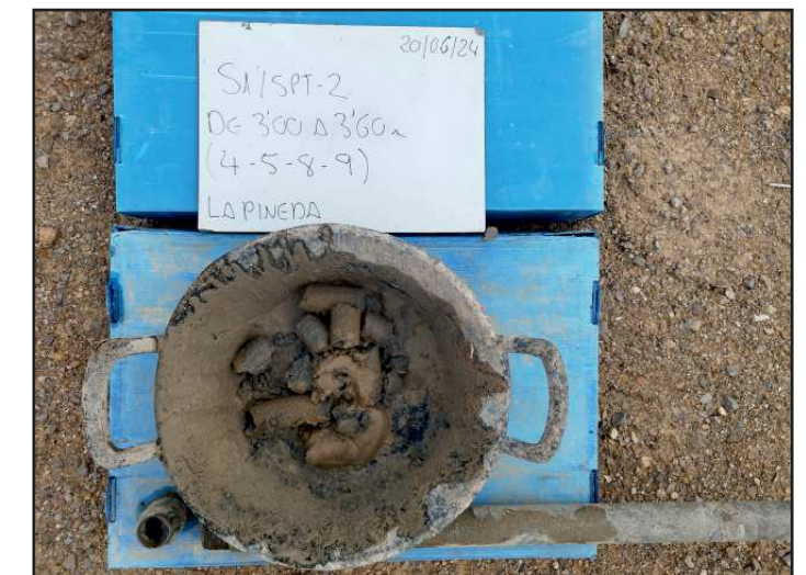
Assaig SPT realitzat entre 3,0 i 3,6 m.
