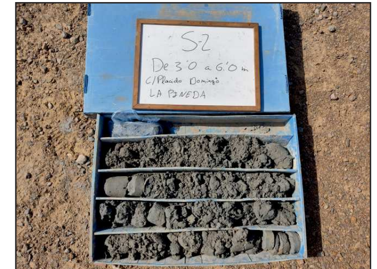
Caixa de testimonis del sondeig S-2 entre 3,0 i 6,0 m.
