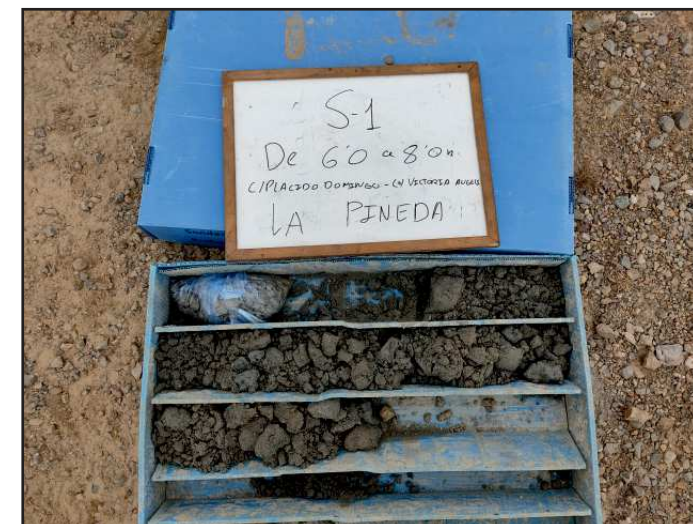
Caixa de testimonis del sondeig S-1 entre 6,0 i 8,0 m.
