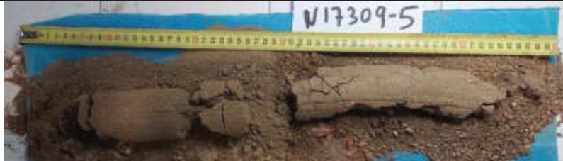
(Nota 1): Asaig fet amb mostra remoldurada compactada a densitat i humitat dessitjats.
