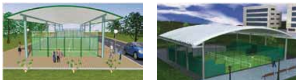
Figura 18. Solución constructiva de una cubierta para dos pistas de pádel en línea
