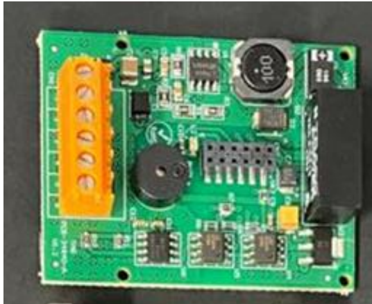
Imatge 5: Vista placa alimentació RFID interruptor CAN
