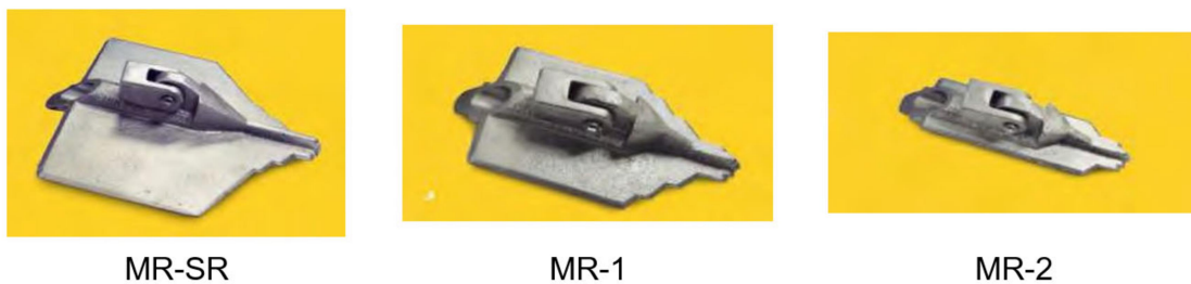
Figura 3. Diferents models de sistema d'ancoratge "Manta-Ray" o DUCKBILL. En els substrats més tous es sol utilitzar el sistema MR-SR (esquerra), en els substrats normals o de duresa mitjana el sistema MR-1 (centre) i en els substrats més durs el sistema MR-2 (dreta)
