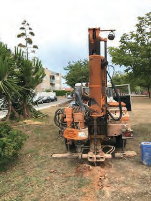
Vistes de quatre dels cinc sondeigs realitzats a la parcel·la objecte d'estudi, S-1, S-2, S-3 i S-4 del tipus Rotació helicoidal.
