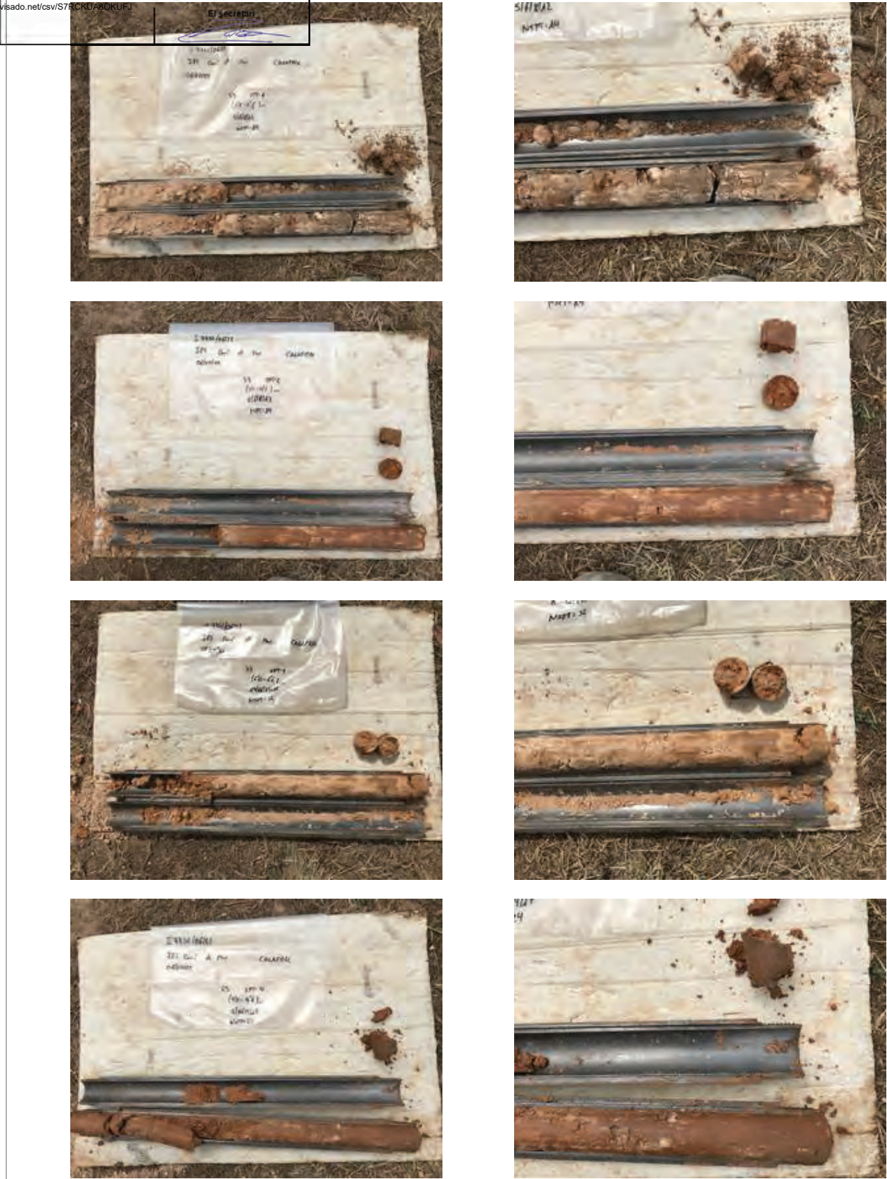
Vistes dels materials del subsòl extrets en quatre assaigs SPT realitzats al llarg del sondeig S-3.
