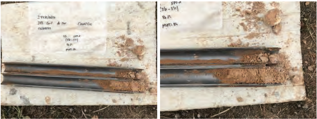
Vistes dels materials del subsòl extrets en un assaig SPT realitzat al llarg del sondeig S-5.
