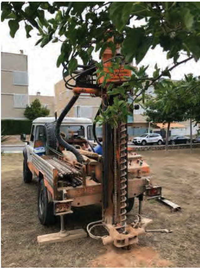
Vistes de un dels cinc sondeigs realitzats a la parcel·la objecte d'estudi, S-5 del tipus Rotació helicoidal.
