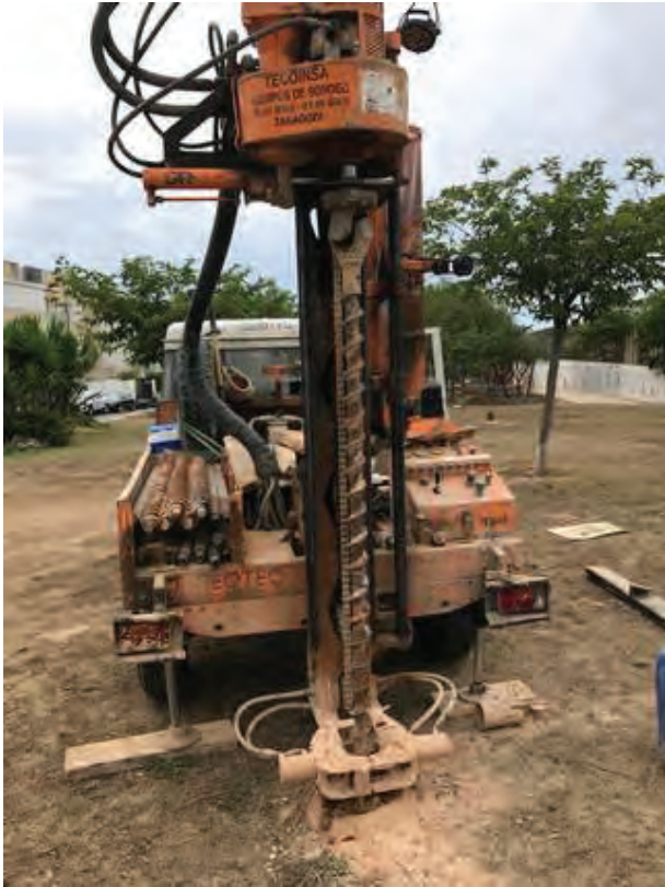
Vistes de quatre dels cinc sondeigs realitzats a la parcel·la objecte d'estudi, S-1, S-2, S-3 i S-4 del tipus Rotació helicoidal.
