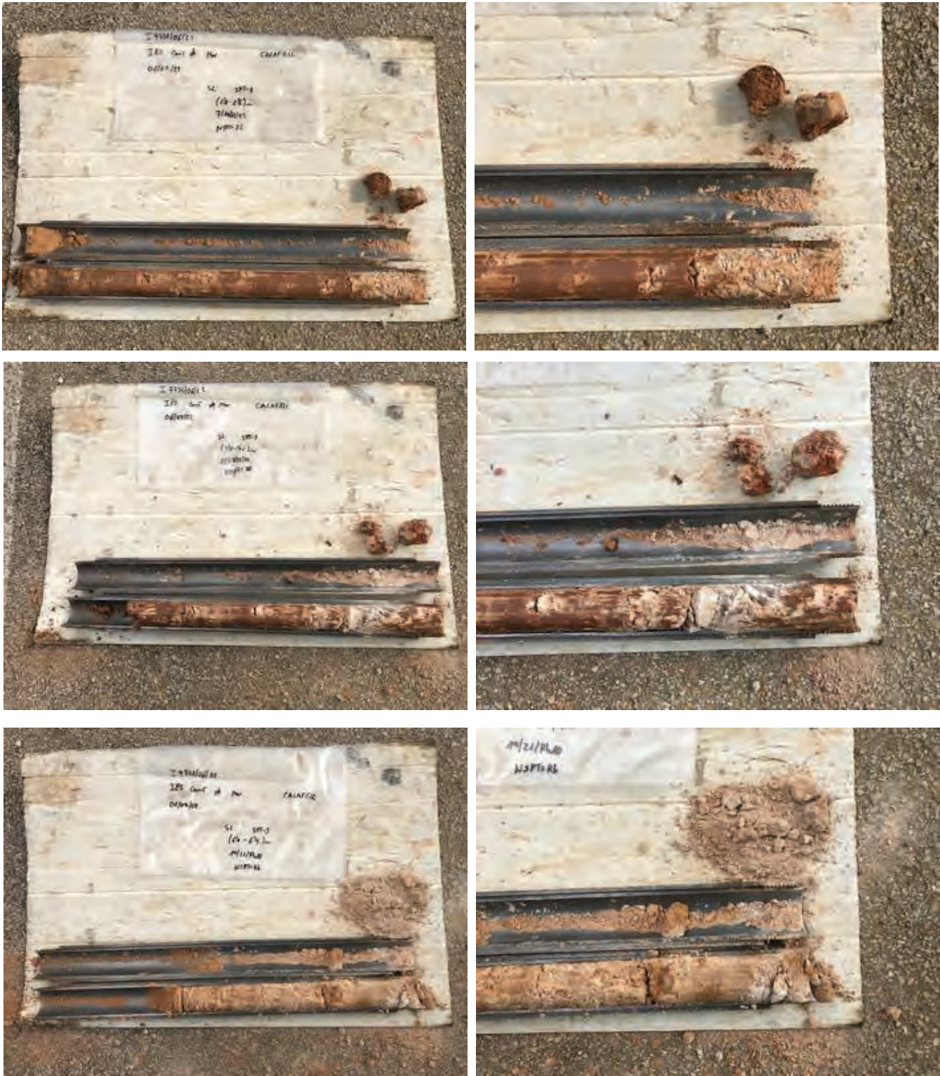
Vistes dels materials del subsòl extrets en tres assaigs SPT realitzats al llarg del sondeig S-2.
