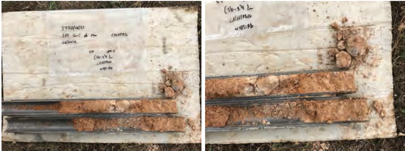
Vistes dels materials del subsòl extrets en dos assaigs SPT realitzats al llarg del sondeig S-4.
