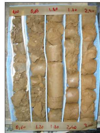
Caixa nº 1: Testimonis extrets del sondeig S-1 compresos entre 0,00 - 3,00 m de profunditat.
