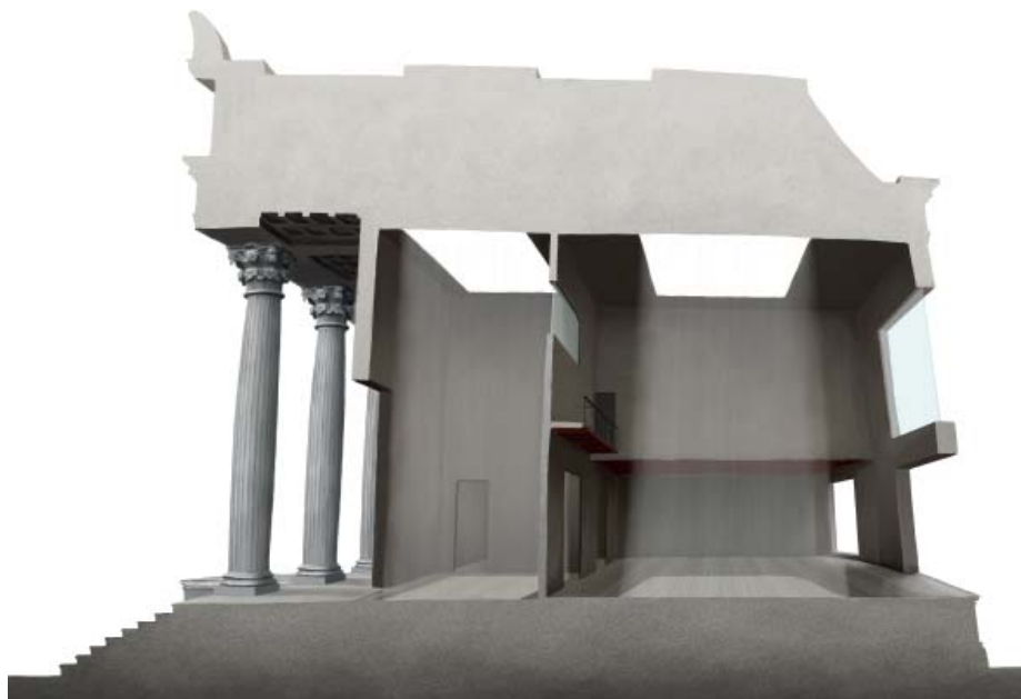
Secció volumètrica longitudinal i transversal del Temple (exclosa la part de coberta i semi-soterrani) en les quals s'observa els dos llenguatges, radicalment diferents, emprats en l'edifici. Les solucions emprades en la part posterior (obertures, xamfrans) responen directament a l'ús de Taller de la gran Sala del Temple.
