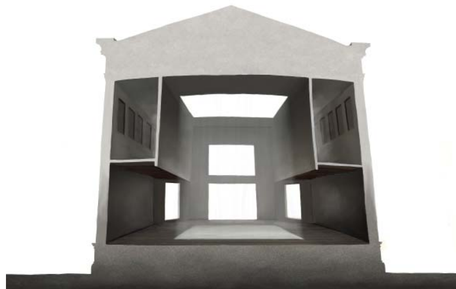
Secció volumètrica longitudinal i transversal del Temple (exclosa la part de coberta i semi-soterrani) en les quals s'observa els dos llenguatges, radicalment diferents, emprats en l'edifici. Les solucions emprades en la part posterior (obertures, xamfrans) responen directament a l'ús de Taller de la gran Sala del Temple.
