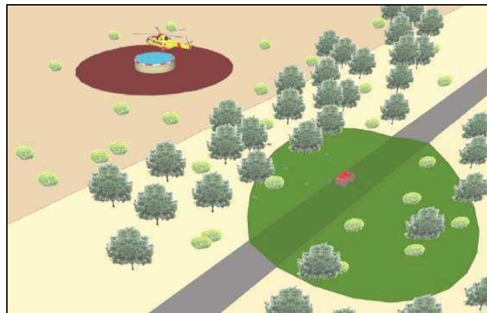
Imatge 1: Esquema de zona de protecció al voltant del punt de càrrega i al voltant del mateix punt d'aigua.
