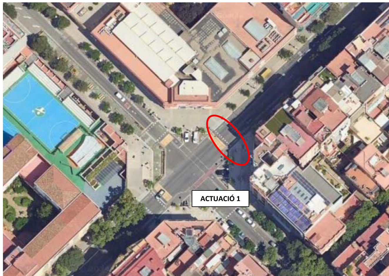
Actuació 1: Nou creuament a calçada de tipus 4c125 situat al Carrer Mallorca des del nou pericó PE03 fins al nou pericó PE04.
