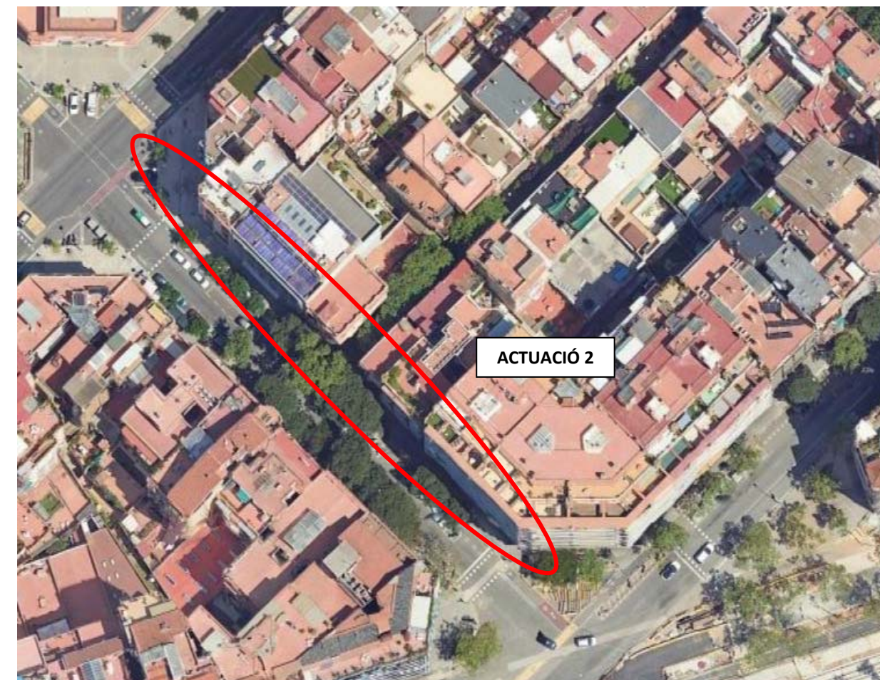
Actuació 2: Nova canalització a vorera de tipus 4c125 des del pericó existent PE02 fins al nou pericó PE03.
