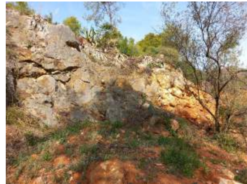
Figura 15. Aspecte de l'aflorament sa del tram II i zona intensament diaclasada i meteoritzada al nord (tram III)
