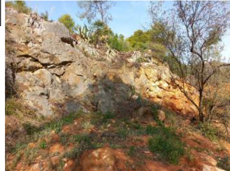
Figura 13. Aspecte de l'aflorament sa del tram II i zona intensament diaclasada i meteoritzada al nord (tram III)
