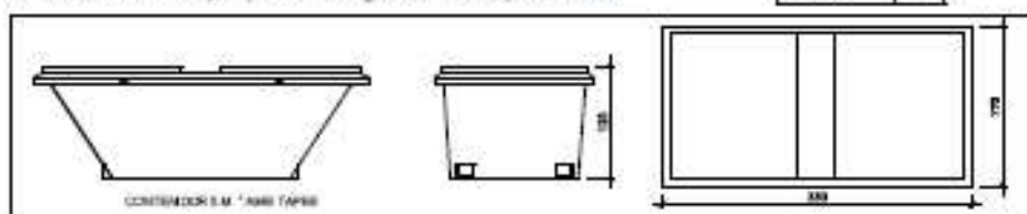
Contenedor 5 m 3 . Apte per a plàstics, paper i cartó, metalls i fusta
