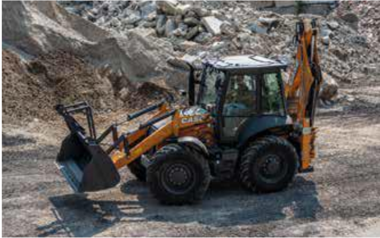
Fotografia de la pròpia excavadora mixta retropala:
