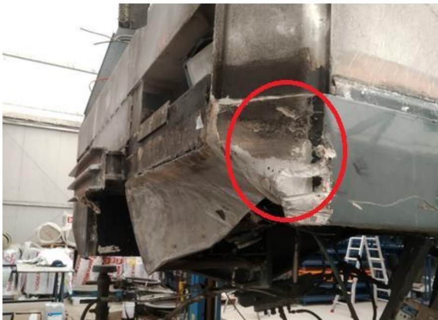
Figura 10: placa metàl·lica tancament de llarguer bastidor esquerra
