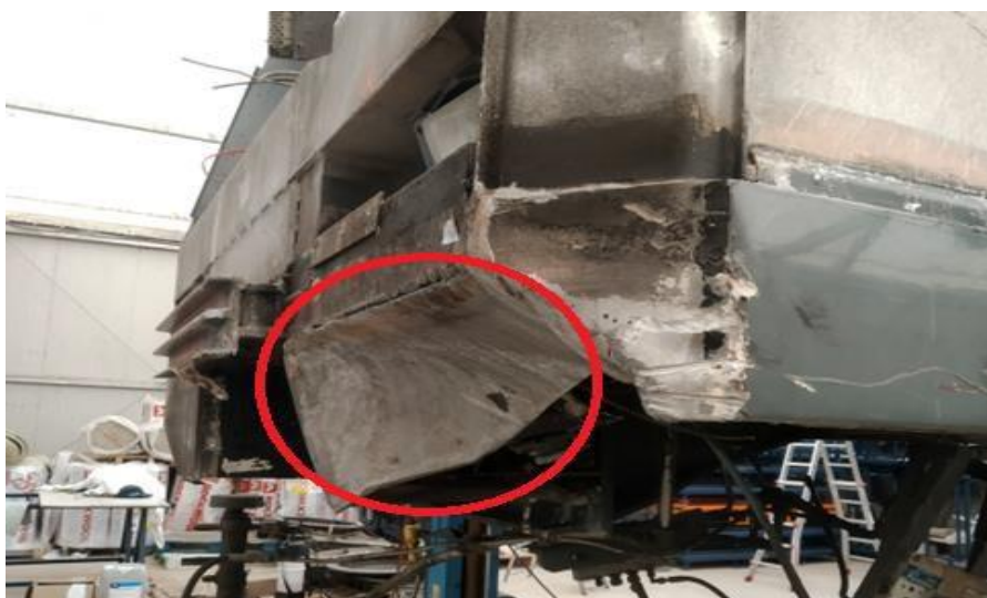
Figura 9: Placa metàl·lica frontal esquerra deformada.
