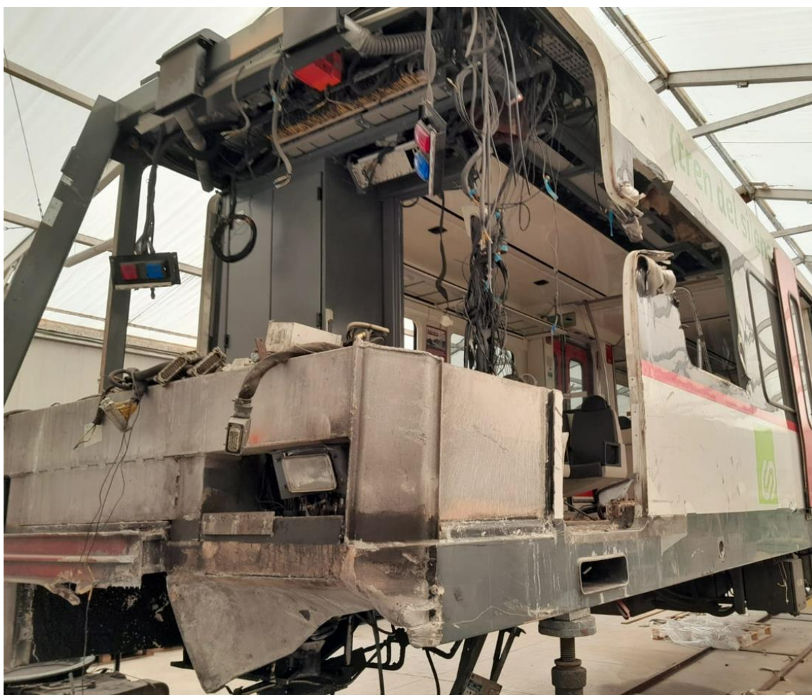
Figura 4: Cabina de conducció afectada
