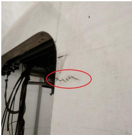
Figura 16: Muntant porta cabina esquerra esquerdada.
