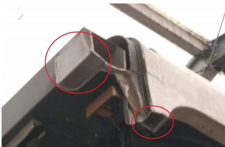
Figura 5: Nus superior esquerra tester cabina, trencat
