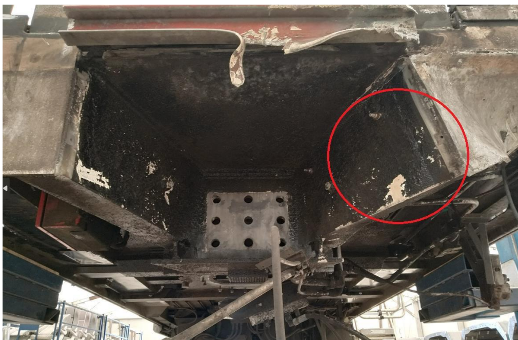
Figura 8: Calaix enganxall deformat.
