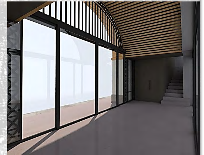
En l'accés principal per l'Avinguda alcalde Palau, es proposa extrusionar l'arc exterior amb un fals sostre de lames ceràmiques vistes, minimitzant la visió de les portes dels bany que queden integrades en el panelat de les parets.
