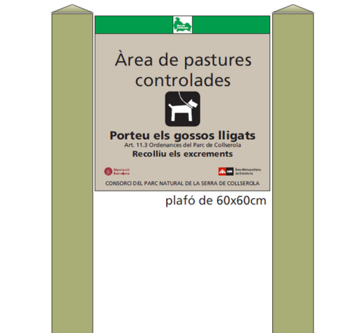
Figura 11 Plafó de 600x600mm amb ala de 25mm de planxa galvanitzada pintada amb poliester amb impressió directe i vernís protector de poliester curat a 180°. Suport format per dos peus drets de fusta de pi amb tractament anticorrosiu de sals metàl·liques (basilit CFK) per immersió i autoclau sistema de buit pressió de 3000x140x140mm. Fixació al terreny amb daus de formigó de 400x400x400mm. Model del Parc de Collserola.
