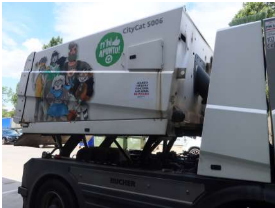
verificación de funcionamiento de la barredora: abertura caja
