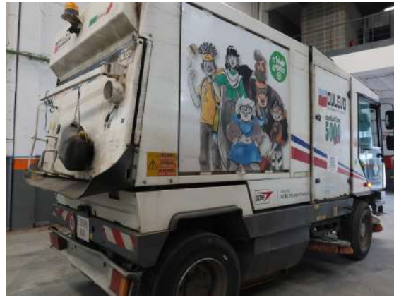
carrocería con algunos desperfectos (por ejemplo deformación paragolpes trasero)
