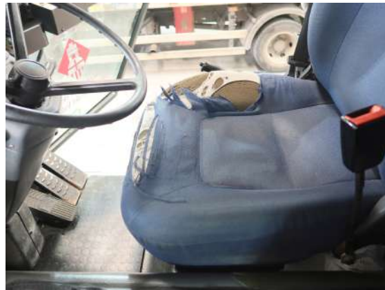
detalle deterioro en asiento por uso
