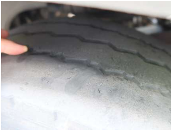
neumáticos algo gastados (todavía dentro de la tolerancia de trabajo)
