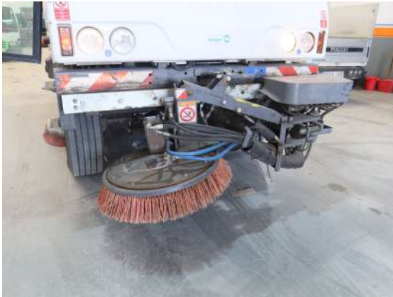
verificación de funcionamiento de la barredora: el cepillo delantero no funciona
