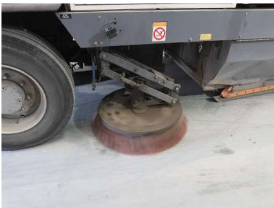
verificación de funcionamiento de la barredora: movimiento cepillo lado izquierdo
