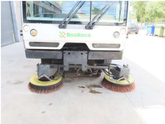
verificación de funcionamiento de la barredora: movimiento de los cepillos
