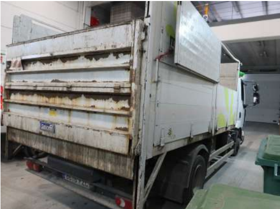
carrocería con algunos desperfectos (chapas oxidadas)
