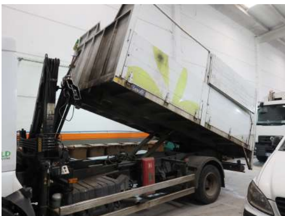
verificación de funcionamiento de la plataforma elevadora: caja elevada
