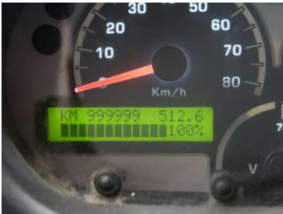
el kilometraje del cuadro de instrumentos no es representativo del uso del vehículo ya que ha llegado al máximo y no vuelve a cero
