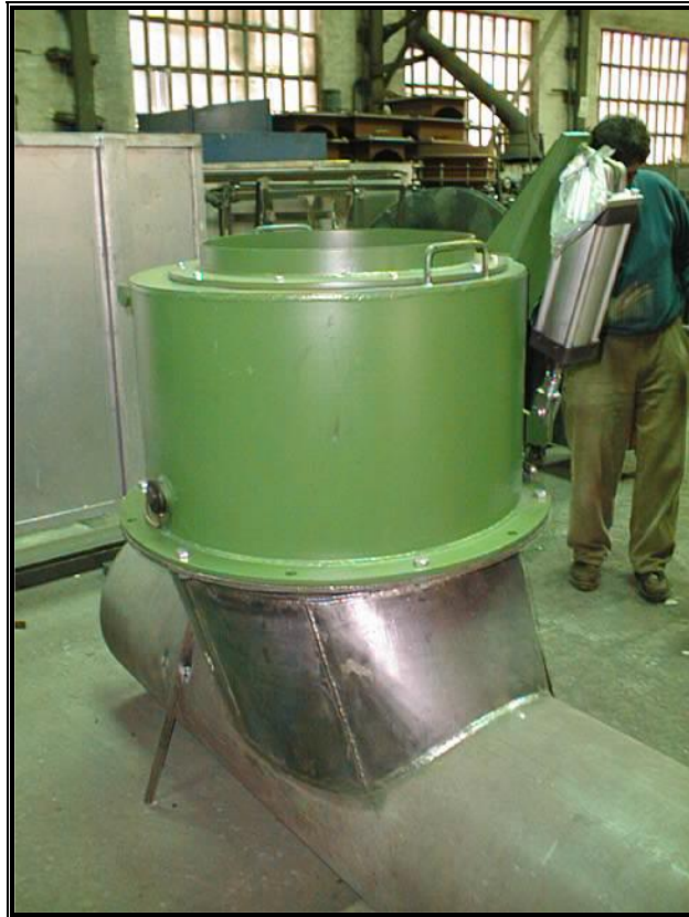
Válvula BDV conectada a injerto en taller
