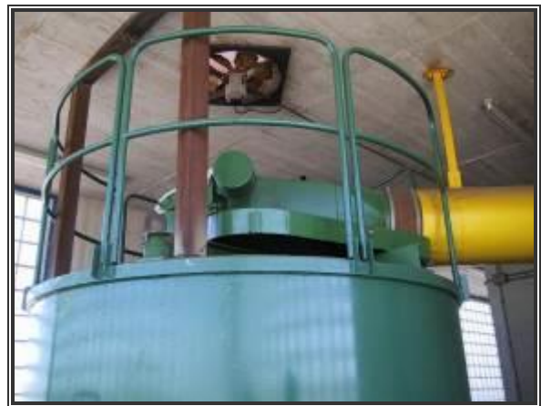
Ciclón de recogida con separador rotativo
