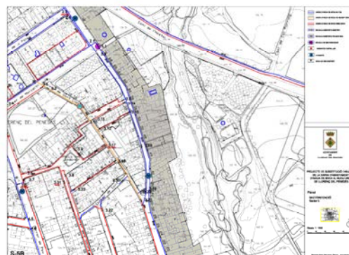
Plànol del sector 5 de la xarxa existent. En color blau les canonades més antigues.
