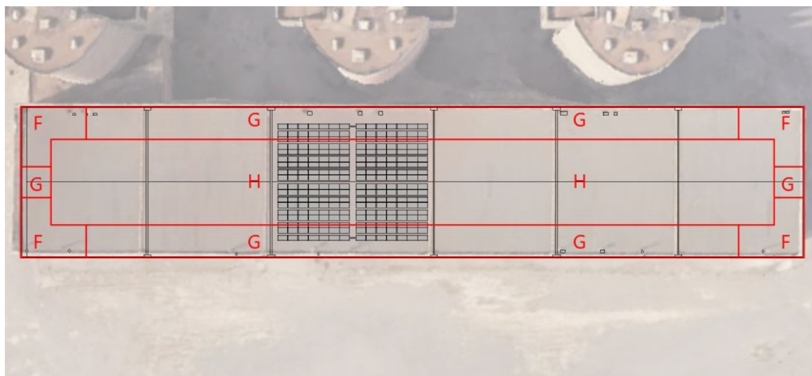
Figura 2.1. Zones de Vent – CTE-SE-AE (coberta plana).
