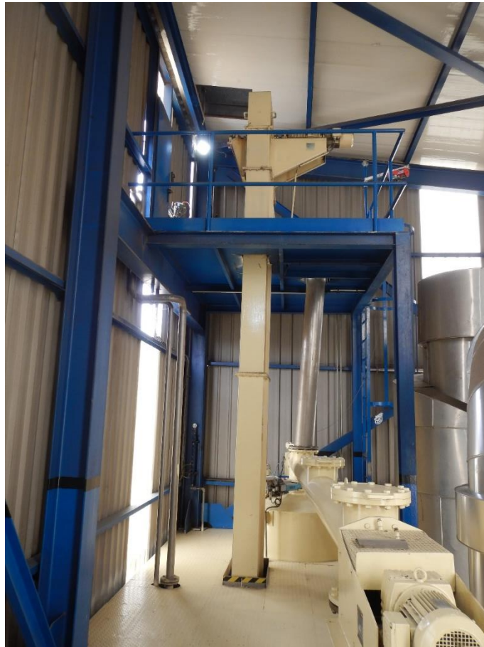
Transportador sinfin H1425, elevador de cangilones H1410
