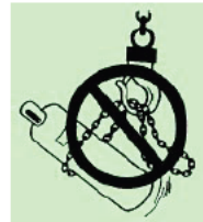
Fig. 2: Indicador de prohibició d'utilització de cadenes o cables per a transportar ampolles de gas
