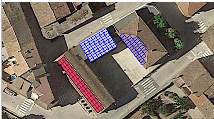
PROYECTO INSTALACIÓN SOLAR FOTOVOLTAICA AUTOCONSUMO DE 60 kWn
