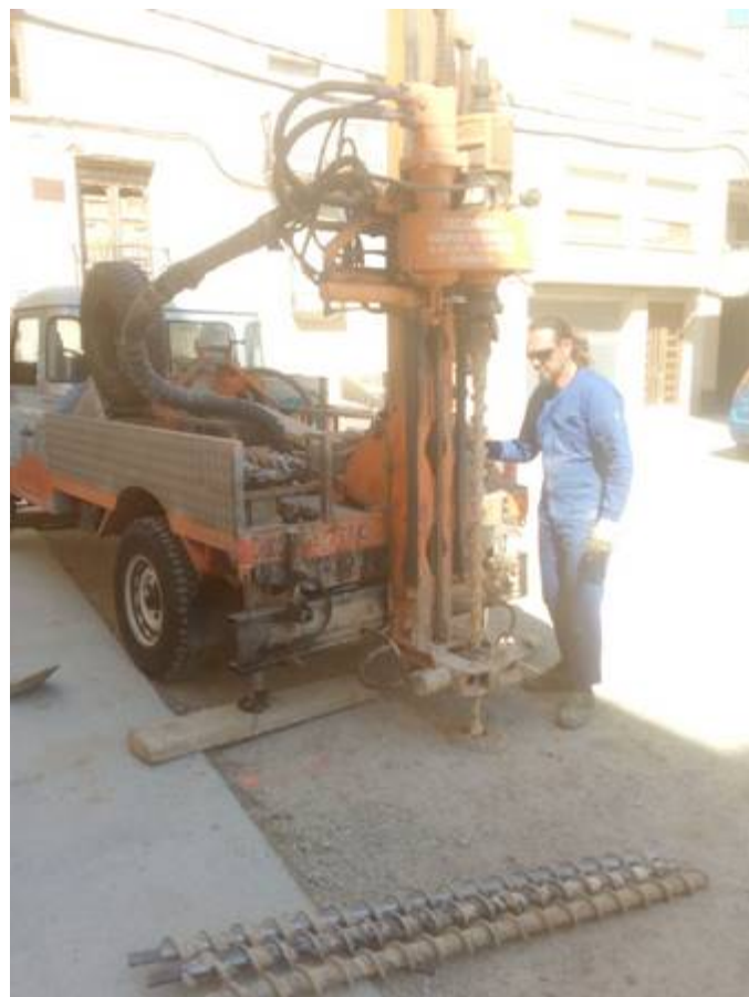
Vistes dels dos sondeigs realitzats a la zona objecte d'estudi, P-1 del tipus DPSH i, S-2 del tipus Rotació helicoidal.
