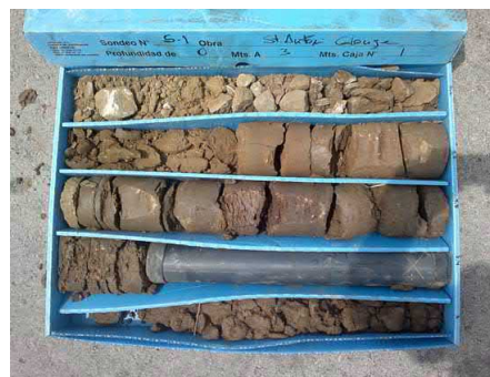
Detall dels materials de reblert detectats de 0 a 0,5 metres al sondeig S-1. Veure renglera superior de la caixa de mostres.
