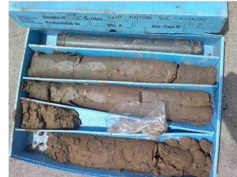
Detall de les argiles i llims marró-grisencs de la unitat Qmd al sondeig S-1, al seu tram entre 3-6 metres.
