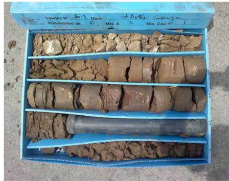
Detall dels materials de reblert detectats de 0 a 0.5 metres sondeig S-1.
