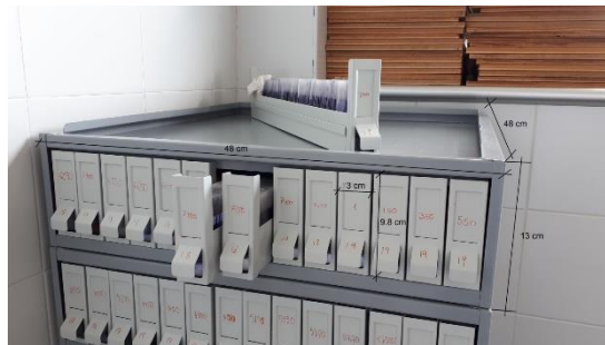
Contenedores de 14 racks para el archivo de vidrios portaobjetos (“laminillas”)
