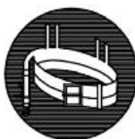
ÚS DE CINTURÓ DE SEGURETAT
