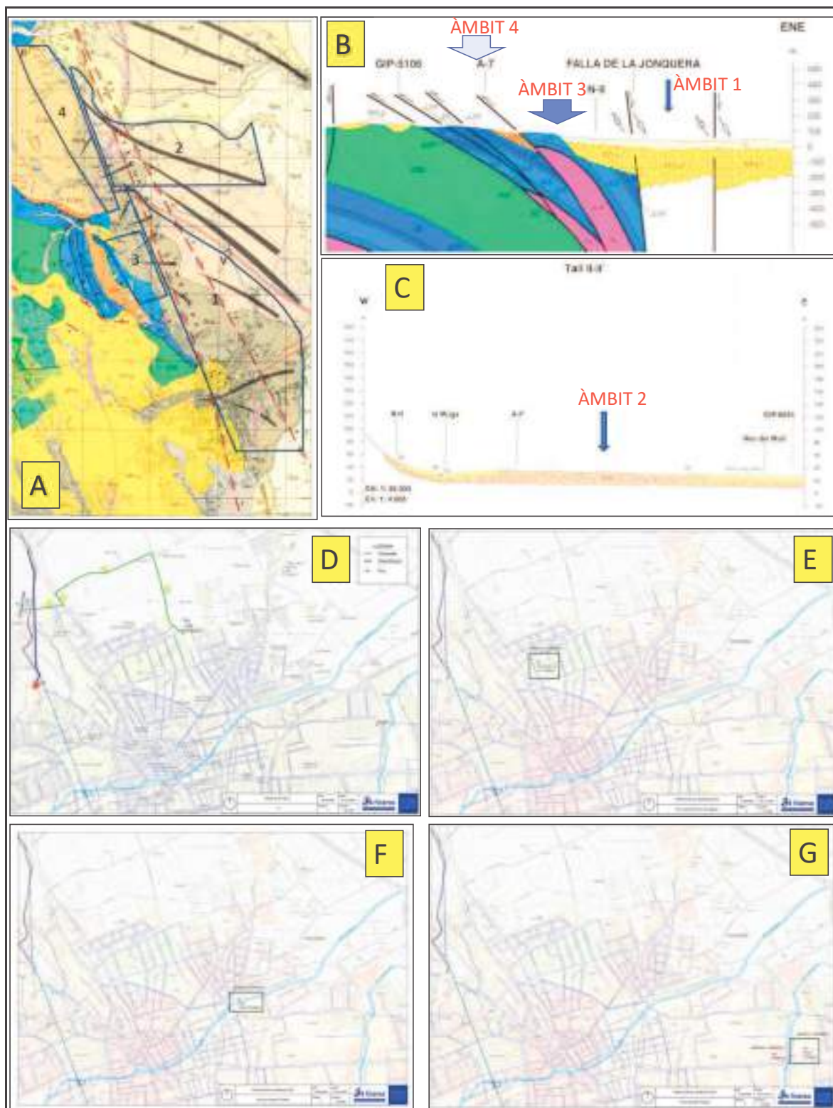
Figura 1 (A), (B) i (C): Àmbits hidrogeològics on s'emmarquen les diferents alternatives plantejades per FISERSA (sobre mapa geològic 1:25.000 de l'ICGC), Figures extretes de la memòria tècnica elaborada per GEOSERVEI (29/02/2024). (D): Plànol d'ubicació on està projectat el POU LLUÍS COMPANYS (Alternativa-1, Àmbit 1). (E): Plànol d'ubicació on està el pou existent POU PARC DE LES AIGÜES (Alternativa-2, Àmbit 1). (F): Plànol d'ubicació on estaria projectat el POU PLAÇA EL·LÍPTICA (Alternativa-3, Àmbit 1). (G): Plànol d'ubicació on son els pous existents de l'antic escorxador de l'empresa FRIDASA (Alternativa-4, Àmbit 1).
