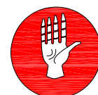
RISC DE CORROSIÓ
