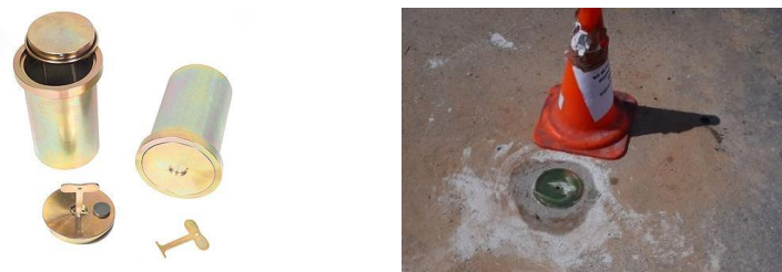
Figura 3: Arqueta final metàl·lica i circular d'entre 120 i 150mm de diàmetre exterior amb junta d'estanqueïtat cimentada al terreny
