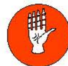
RIESGO DE CORROSIÓN
