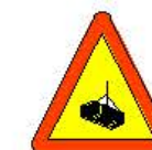
RIESGO CARGAS SUSPENDIDAS
