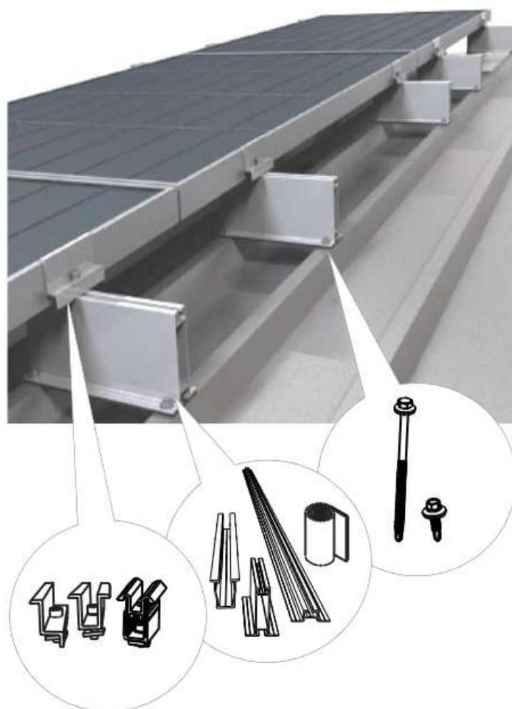
Fig. 4 Esquema instal·lació estructura mòduls fotovoltaics.
