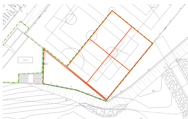
Noves juntes de dilatació solera (color vermell)
