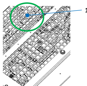
Fig. H-9: Comprobar el estado del refrigerante a través de la rejilla de aire
