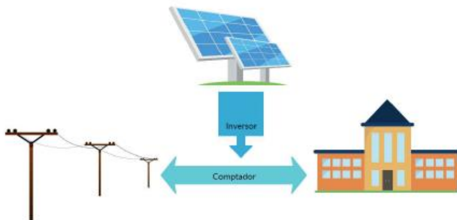
Il·lustració 9 - Esquema bàsic d'injecció a xarxa
