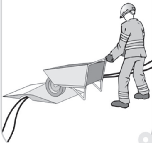
protección de conductores
