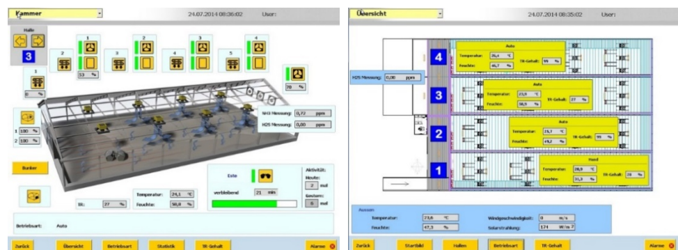
Interfaz de usuario del control ClimaControl (ejemplo: vista de una y varias naves)
