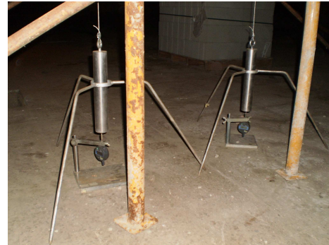
Fotografia núm.4: Situació micròmetres PROVA 2
