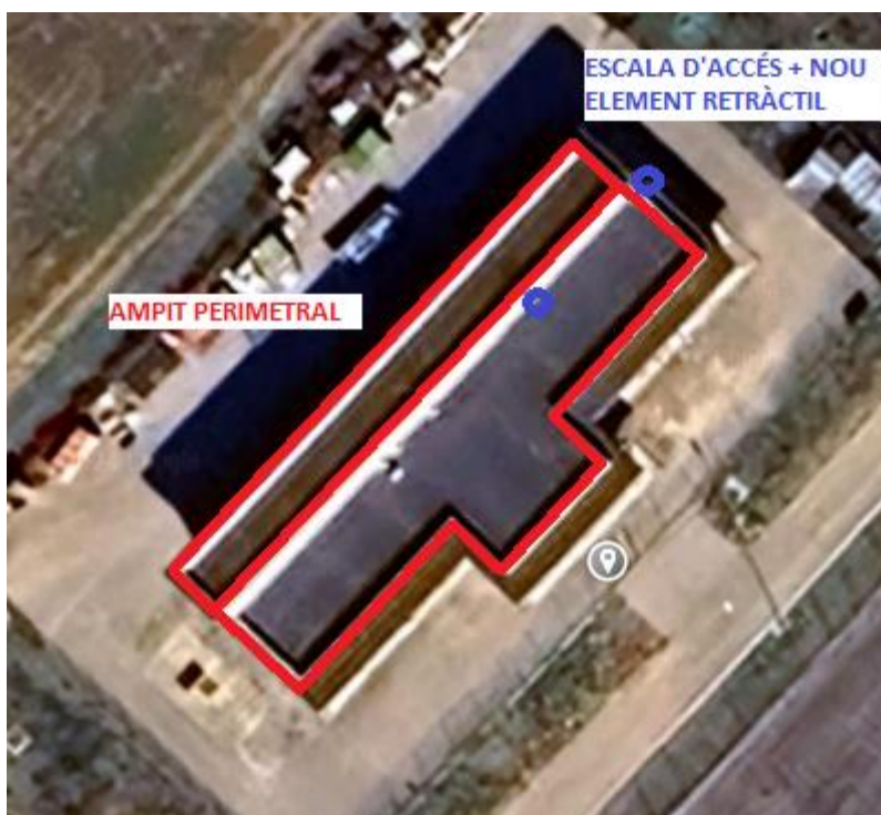
Figura 18 Proteccions col·lectives i accessos
