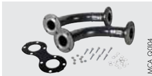
Juego de codos de 90°: - DN 65 mm para los sistemas en cascada de 80 a 428 kW - Bulto HC209 - DN 100 mm para los sistemas en cascada de 428 a 1070 kW - Bulto HC210
