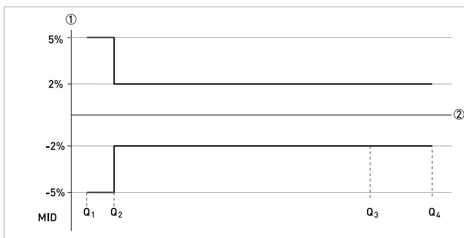
Figura 6-2: Velocidades de caudal ISO añadidas a la figura para una comparación con MID
