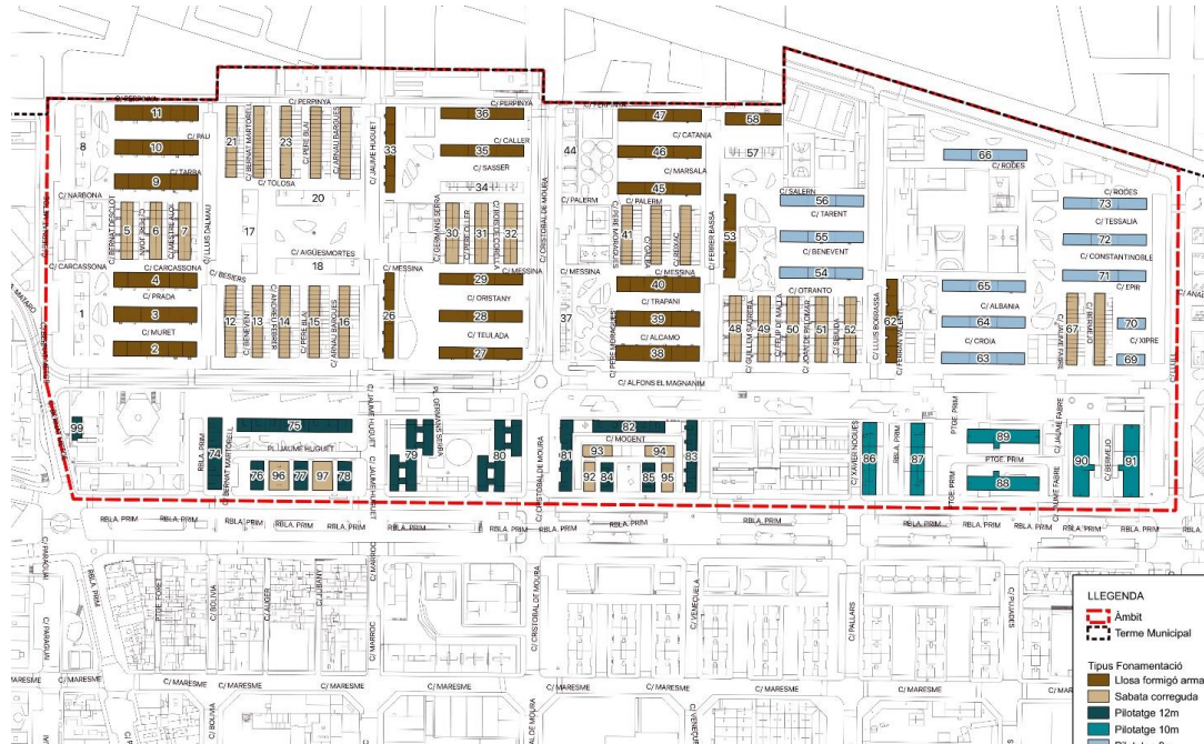
Imatge 4. Plànol d'ubicació dels diferents sistemes de fonamentació utilitzats al barri.
