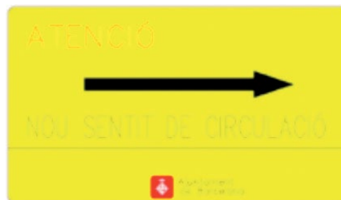
Pancartes de PVC Fons groc, lletres negres, tall vermell. Dimensions: 600x300 mm mínim. Lletra Helvetica Medium Condensed.
